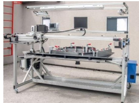
Stanowisko do kontroli uszczelki z funkcją automatycznego zapisu i transmisji danych
