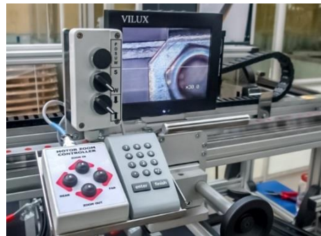
Stanowisko do kontroli uszczelki z funkcją automatycznego zapisu i transmisji danych
