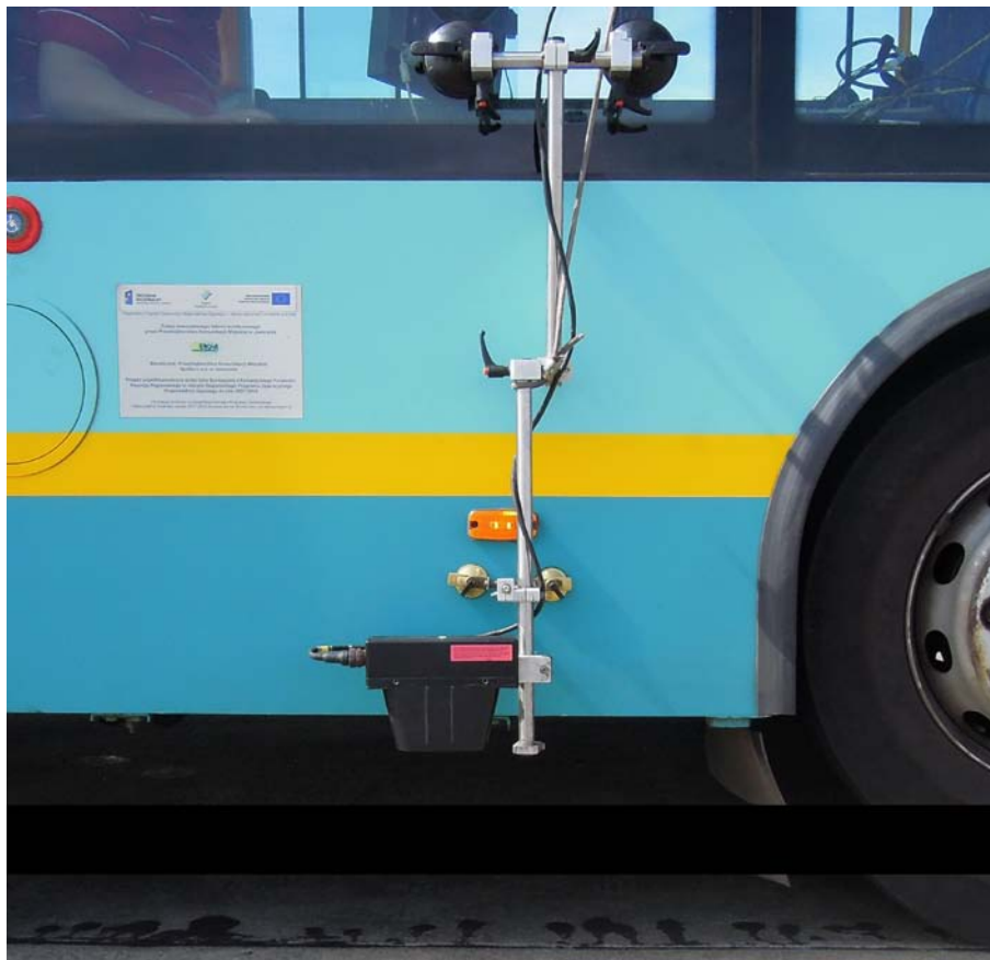
Rys. 4 Głowica optyczna Correvit zamontowana na pojeździe (pomiar prędkości i drogi)
